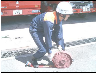
④メス金具付近を右足で踏み、オス金具を両手で持ち延ばす
