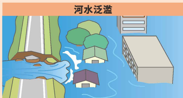
大雨导致河川水流量大幅增加，水从堤坝溢出或者堤坝决堤导致水外溢的现象被称为“外水泛滥”。
