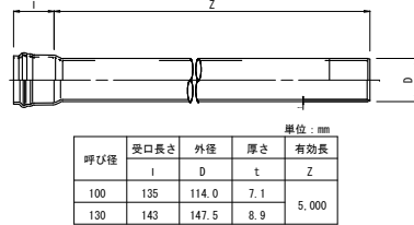
耐衝撃性硬質塩化ビニル管 (ゴム輪片受直管) (RR-CCVP φ100, φ130)
