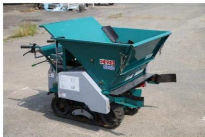
アテックス 堆肥散布車 (堆肥・肥料の散布)
