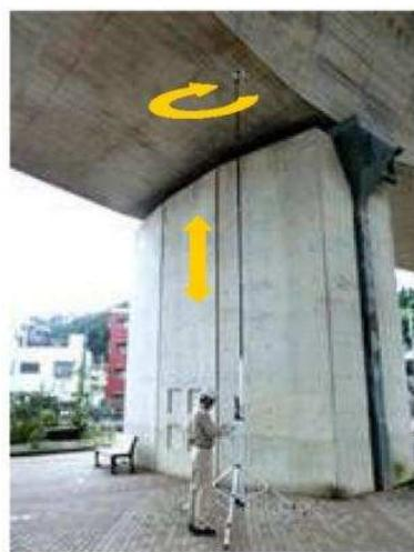
図 4.1-1 新技術における点検事例（機材） 図 4.1-2 新技術における点検事例
