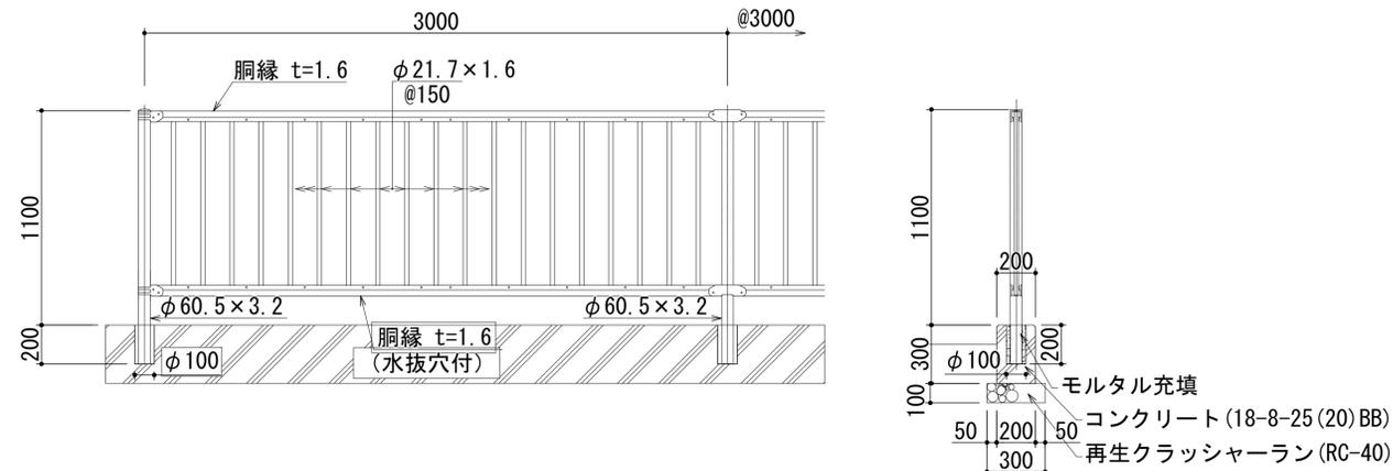
※外装は亜鉛・アルミ・マグネシウム合金めっきの上高耐候性樹脂粉体塗装とする。
