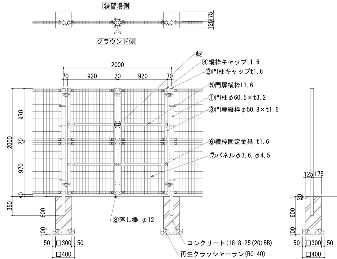
①～④は、静電粉体塗装(下地亜鉛・アルミ・マグネシウム合金めっき)
