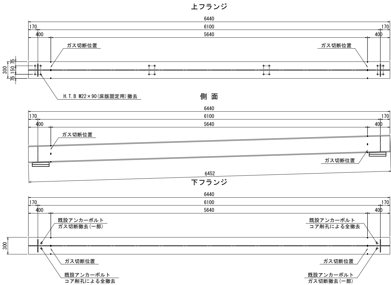
主桁撤去詳細図 S=1:20
