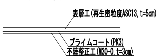
標準断面図 (車道部) (密粒度ASC 5cm箇所)
