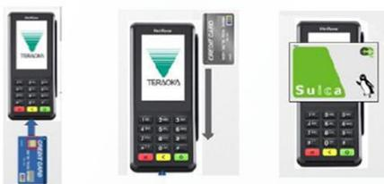
IC読み取り 磁気スリット 非接触型
